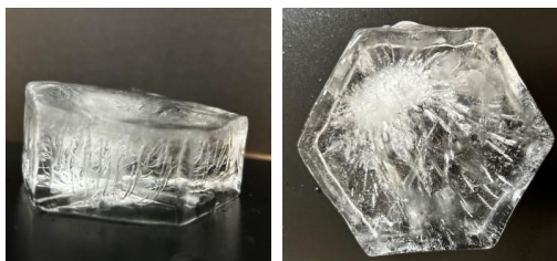
図27 凝固点降下を利用して生成された透明氷
