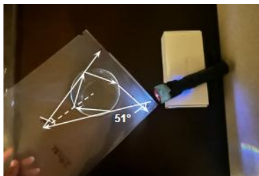
図17 副虹再現時の光の反射角
