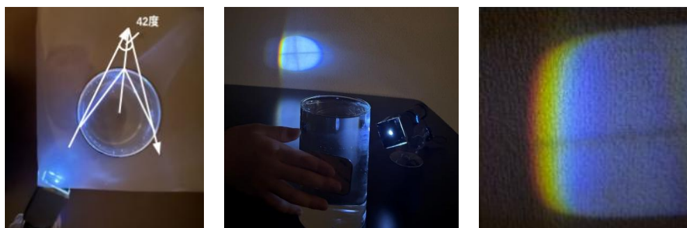
図15 主虹の再現（左から再現時の光の反射角・再現時の様子・再現された虹）
