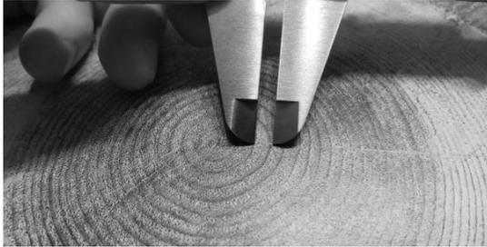
図1 ノギスでの幅の測定の例
