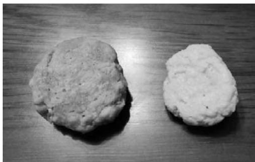
図6 牛乳・豆乳から作った生分解性プラスチックの比較1
