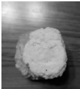
図7 牛乳・豆乳から作った生分解性プラスチックの比較2
