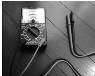
写真6：電圧測定のテスター
