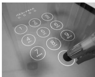
図7 軸…プラスチック ペン先の抵抗… 2\text{億}\ \Omega 以上 反応していない
