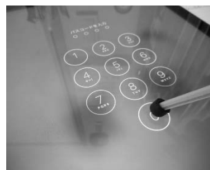
図8 軸…木 ペン先の抵抗… 2\text{億}\ \Omega 以上 反応していない
