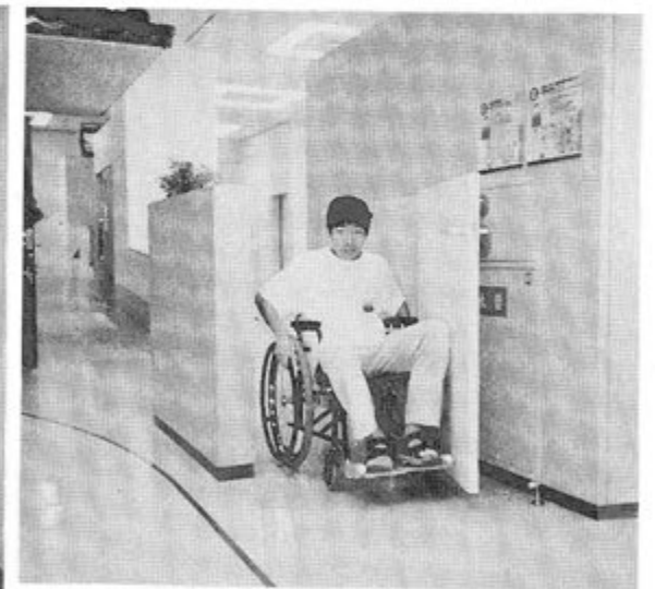
車イスにのったまま、ドアを開けてみました。このドアは、すぐに閉まってくるので大変でした。また、傾斜があると、車イスを静止させておくことも難しいことがわかりました。
