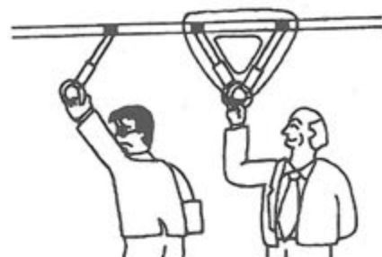
▲図4 吊り皮とトラスの原理
