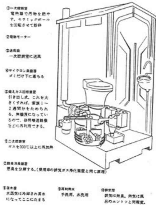
燃焼トイレ構造図
