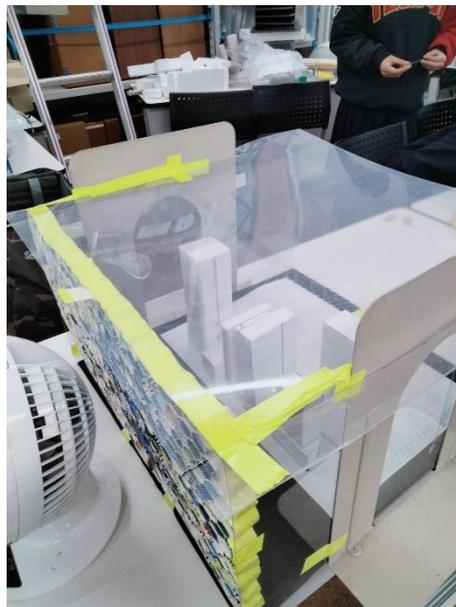
図2 風洞装置
