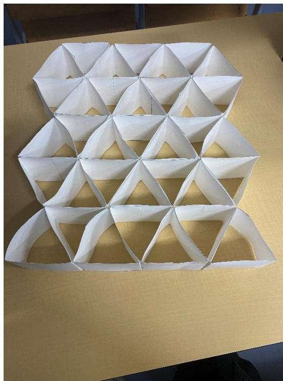
図3 実際に使用したトラス構造
