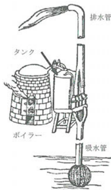
図1 セーヴァリポンプ ダンネマン大自然科学史6を加筆修正
