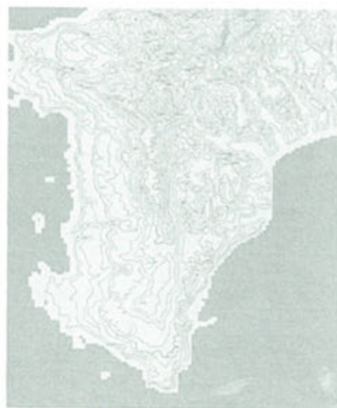
図11 等高線のみ地形図 (佐渡島の海岸段丘、相川町の等高線を10mごとに表示)
