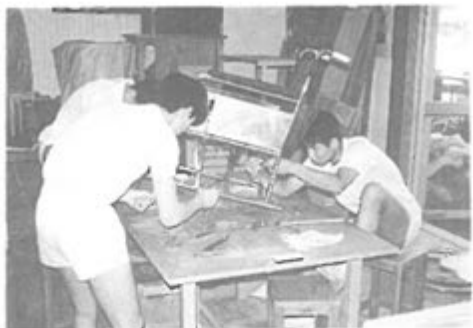
写真5 車椅子の分解修理・整備②
