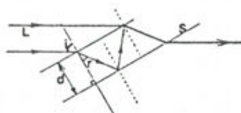
図2 Sはシャボン玉の膜、Lはシャボン玉の膜を透過する平行光線、 i は入射角、 r は屈折角、 d はシャボン玉膜の厚さ。
