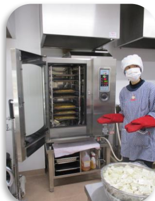
給食づくりには欠かせないスチームコンベクションは「焼く」「蒸す」などができる、多機能な加熱機器です。
